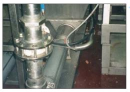
Клиент, производящий мясо, механически отделяемое от костей, которое замораживается перед отправкой производителям пищевых продуктов, установил насос W062 из нержавеющей стали. Мясное филе под действием собственной тяжести попадает во входной накопитель для подачи затем в морозильную камеру. Для эффективной работы морозильной камеры необходима постоянная скорость подачи - 5 тонн в час, чтобы предотвратить простои или задержки в последующих технологических цепочках.
