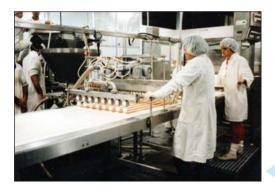
Ведущий разработчик и производитель оборудования для производства тостов, пирожков и сосисок, запеченных в булочку установил насос W032 из нержавеющей стали на установку по производству запеченных сосисок. Для постоянной подачи подготовленного мясного фарша на заданную длину в оболочку из теста со скоростью 5-10 куб. м/час насосы серии W должны иметь систему шнековой подачи, которая обеспечит непрерывную подачу мясного фарша из широкой горловины в рабочий узел насоса.
